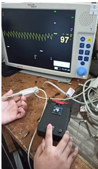
Gambar 10. Pengujian Hardware dengan Patient Monitor Dash4000
