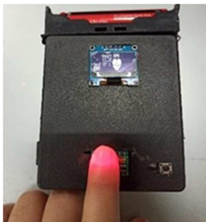
Gambar 7. Percobaan Pengukuran Heart Rate dan SpO 2 dengan Alat Penelitian
