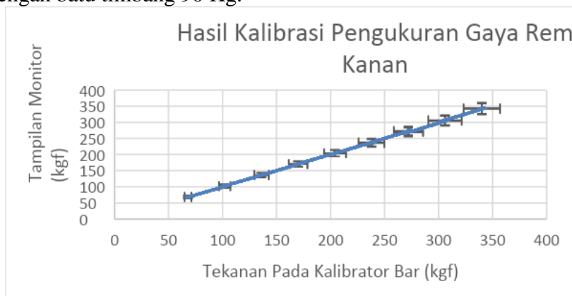
Gambar 3 Hasil Kalibrasi Pengukuran Gaya Rem-Kanan
