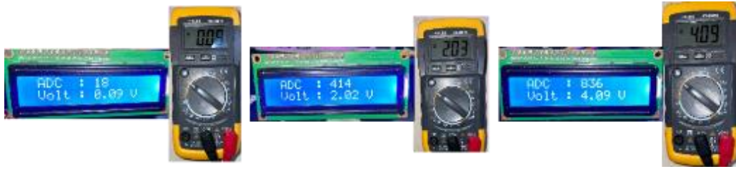
Gambar 10 Pengujian sensor LDR
