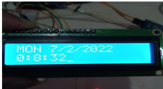
Gambar 9 Pengujian RTC Jika Dilihat Pada LCD 16x2 I2C
