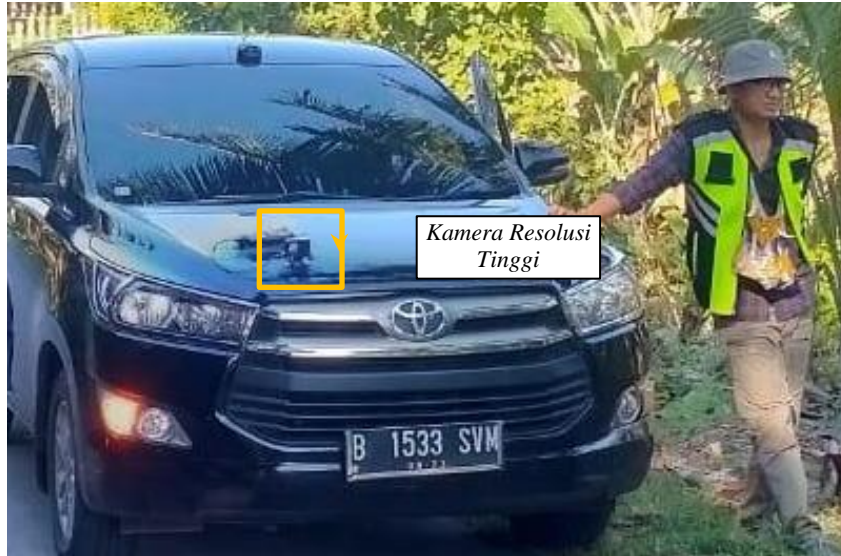
Gambar 2. Penempatan kamera resolusi tinggi pada Mobil
